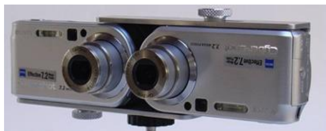
Figura 7 – Técnica de captura side-by-side .
