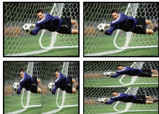
Figura 4 - Exemplo das diferentes codificações frame-compatible stereo [3].
