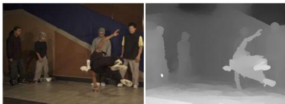
Figura 6 - Ilustração do mapa de profundidade de uma imagem utilizado no formato depth-based [3].
